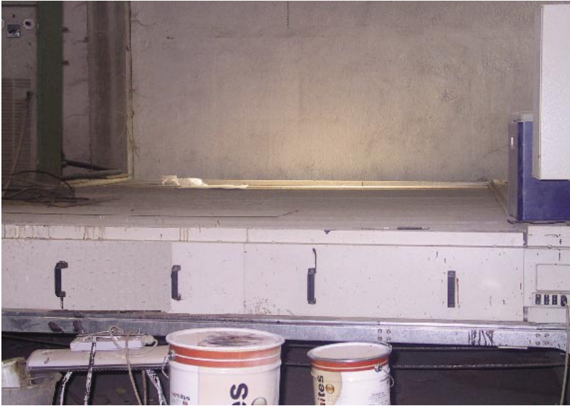
4. Il forno traslatore ad aria calda (30 °C).
