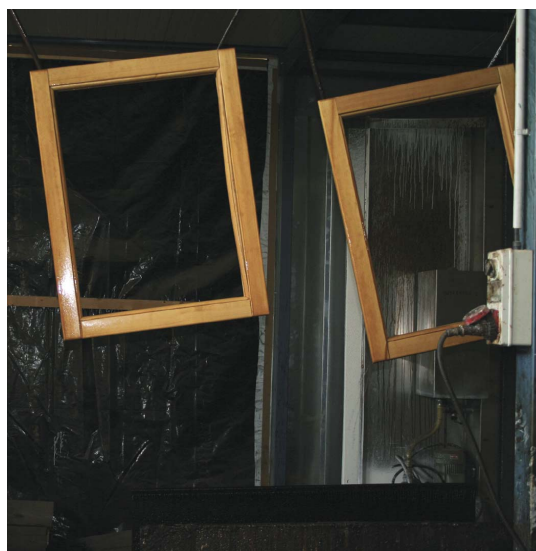
3 - I pezzi in uscita dal flow coating.
