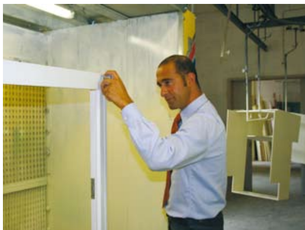
9 - Si misura lo spessore della finitura.
