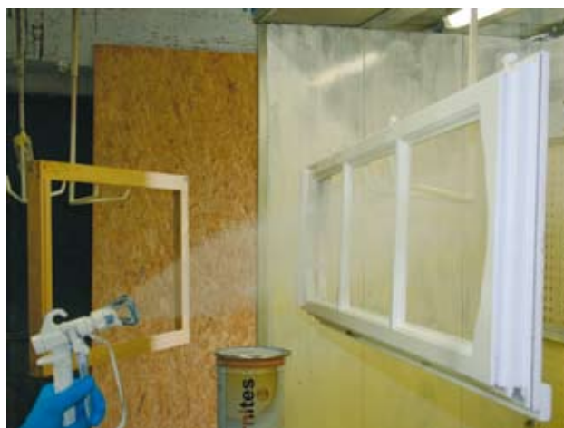
7 - L'applicazione della prima mano di fondo all'acqua.
