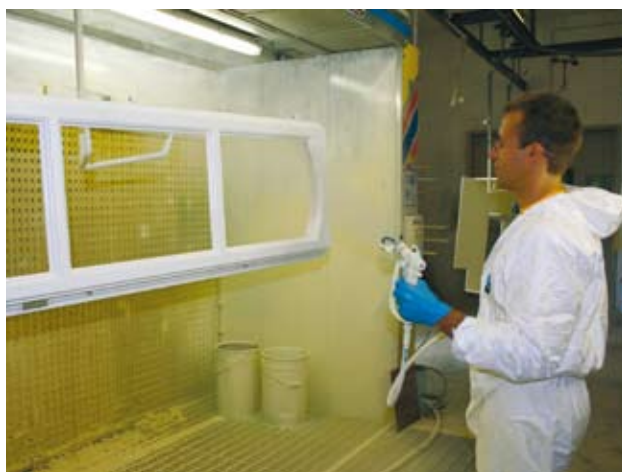
8 - L'applicazione della mano di finitura all'acqua.
