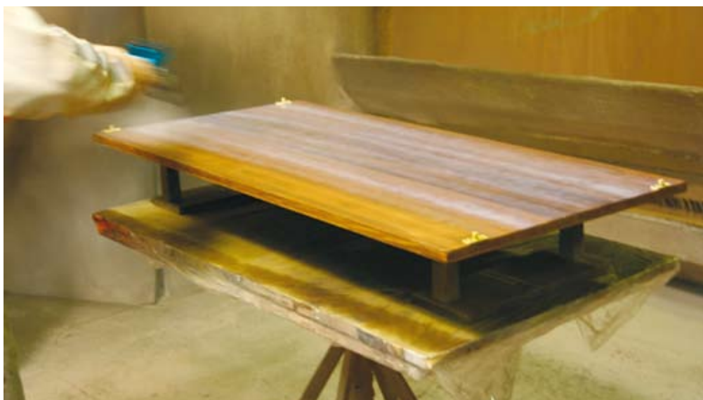
8 - L'applicazione a spruzzo della finitura bicomponente all'acqua.
