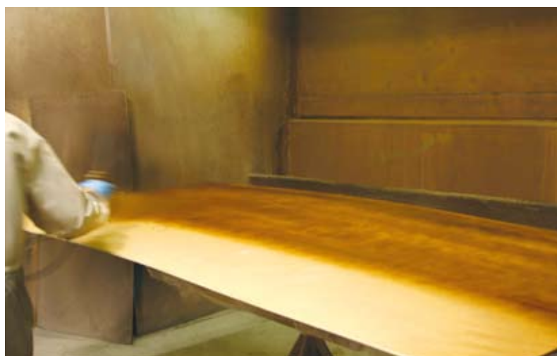
6 - L'applicazione a spruzzo del fondo bicomponente all'acqua.
